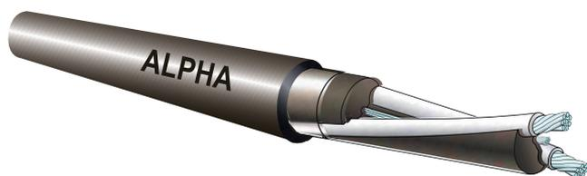
Альфа кабель (GDALPHA) - прецизионный распределённый датчик вибраций, разработанный специально для применения в системах охраны периметров. Альфа кабель представляет собой линейный электромагнитный микрофон. Он содержит пару протяжённых полимерных магнитов, в зазорах между которыми расположены два подвижных проводника. При вибрациях ограды проводники сенсора перемещаются в магнитном поле, и в результате в них наводится электрическое напряжение.
