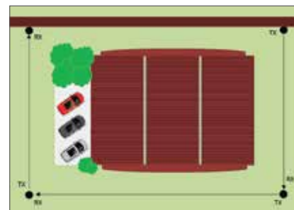
установка одно- и двунаправленных колонн
