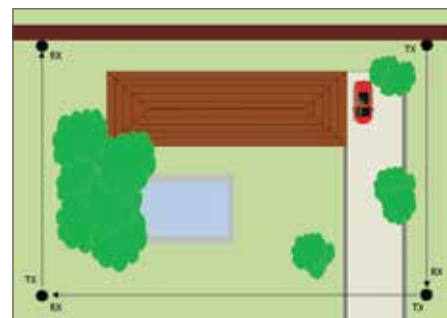
установка одно- и двунаправленных колонн
