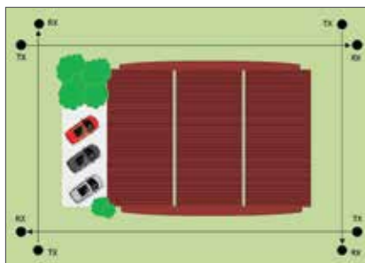
установка однонаправленных колонн
