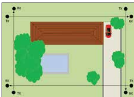
установка однонаправленных колонн
